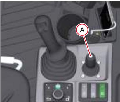
Fig. 136: Levier de la lame niveleuse
