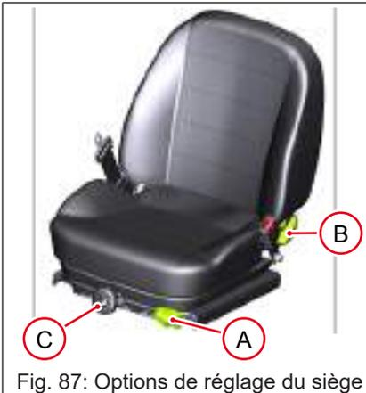
Fig. 87: Options de réglage du siège
