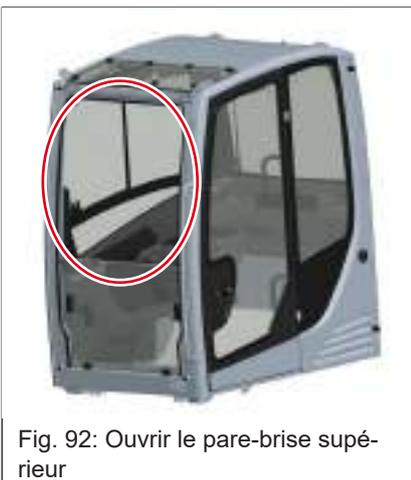
Fig. 92: Ouvrir le pare-brise supérieur
