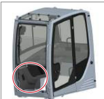
Fig. 95: Ouvrir le pare-brise inférieur
