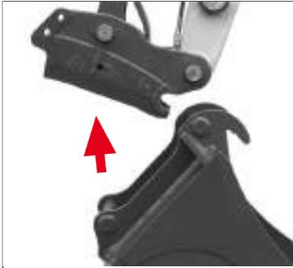
Fig. 212: Déposer l'équipement
