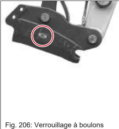
Fig. 206: Verrouillage à boulons
