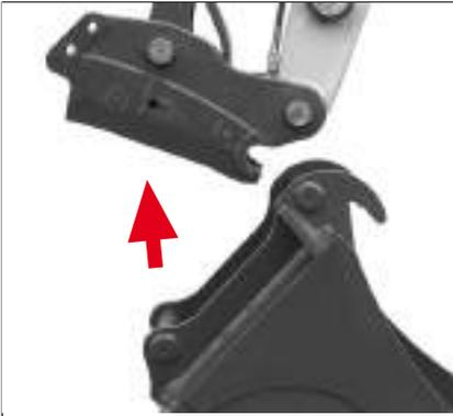
Fig. 219: Déposer l'équipement
