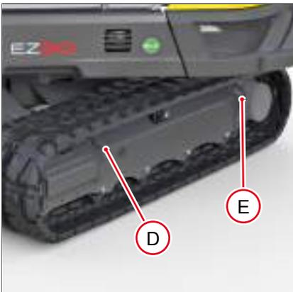
Fig. 249: Œillets d'ancrage châssis extérieur
