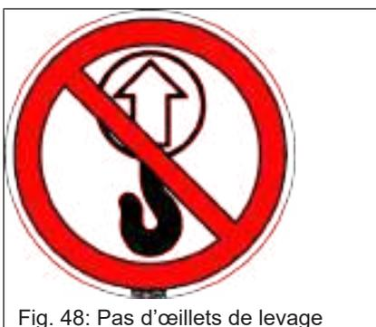
Fig. 48: Pas d'œillets de levage
