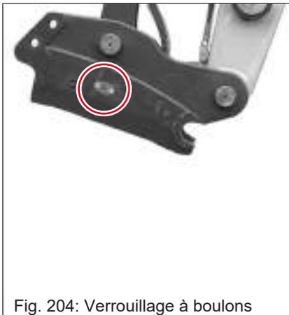
Fig. 204: Verrouillage à boulons
