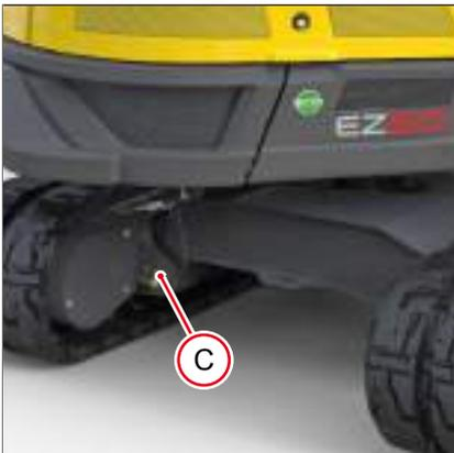
Fig. 248: Œillets d'ancrage châssis intérieur
