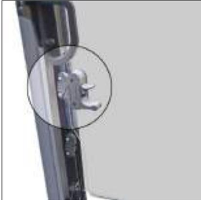
Fig. 99: Ouvrir/fermer l'ensemble du pare-brise
