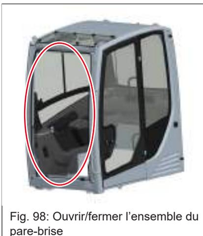
Fig. 98: Ouvrir/fermer l'ensemble du pare-brise
